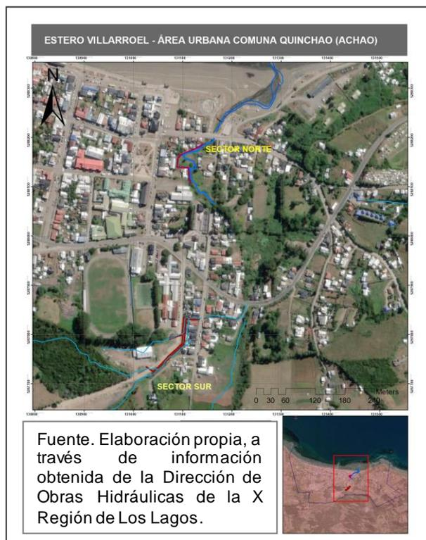
La Figura muestra las obras de defensa fluvial en el sector norte del estero Villarroel, y en el sector sur se observa la canalización realizada del drenaje secundario.
